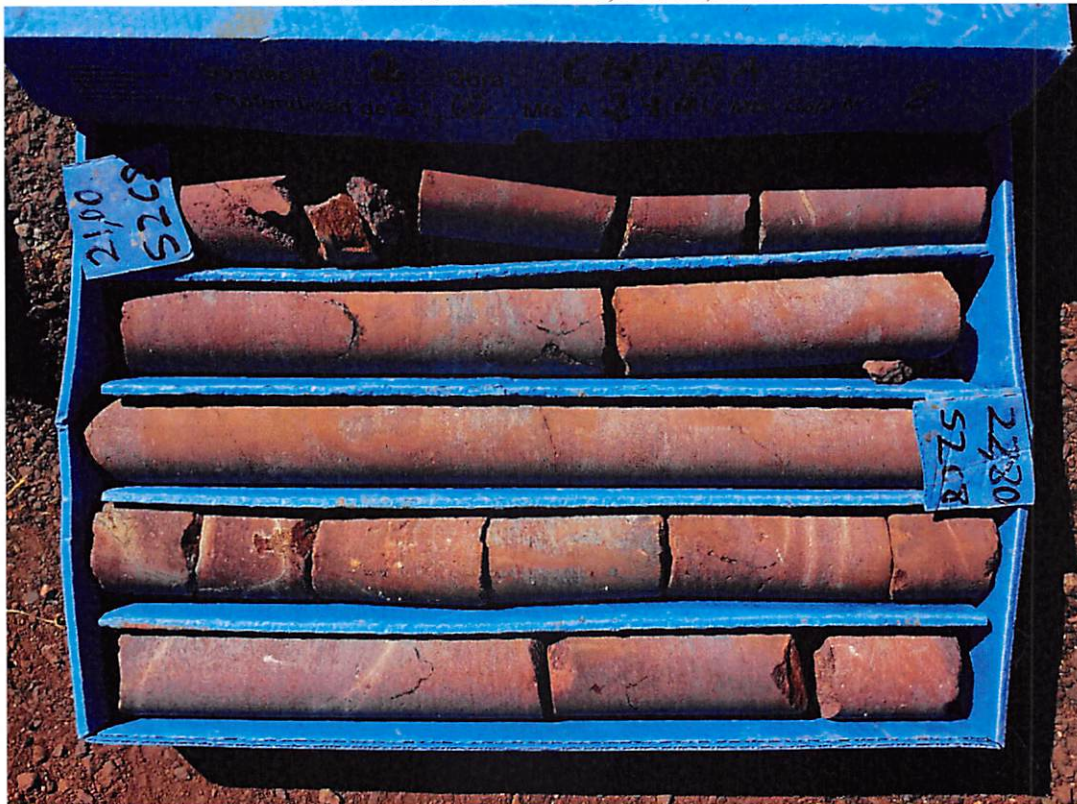
Foto 30: Sondeo 2 de 21,00 a 24,00 m
