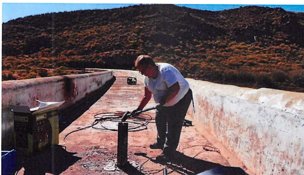
Figura 18. Imagen de la viga de acero hincada en coronación durante los trabajos de adquisición de datos de Down-Hole.
