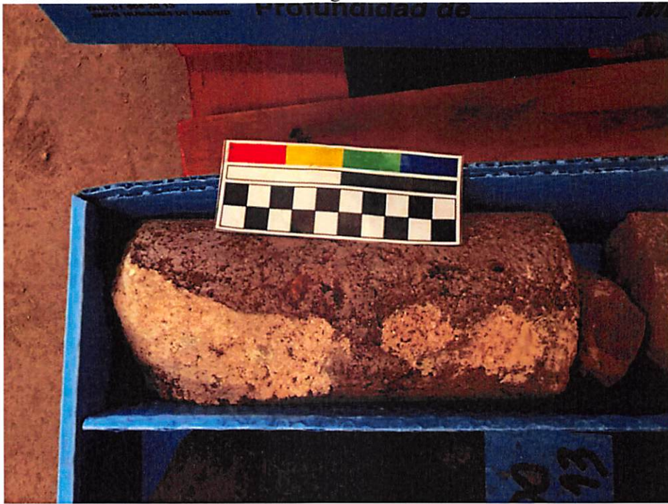
Foto 33: Detalle nivel de bolos con argamasa del sondeo 1 de 40,9 a 46,00 m
