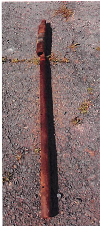
Figura 21. Obturador y varillaje empleado en la ejecución del ensayo.
